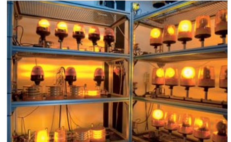
Lebensdauerprüfung verschiedener Kennleuchten-Serien
